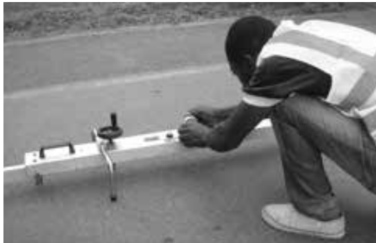
Fig. 3 Déroulement de la campagne : mesures des déflexions.
