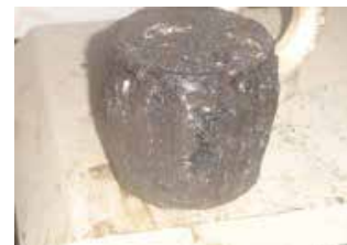
Figure 9: Éprouvette de BB à la rupture, après compression simple
