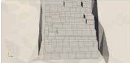
Figure 9 Découpage de la zone délimitée en blocs
