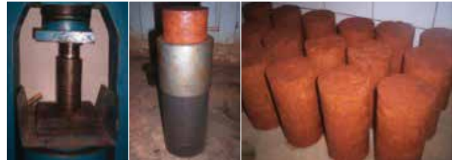
Figure 7: Confection des éprouvettes de grave latéritique naturelle
