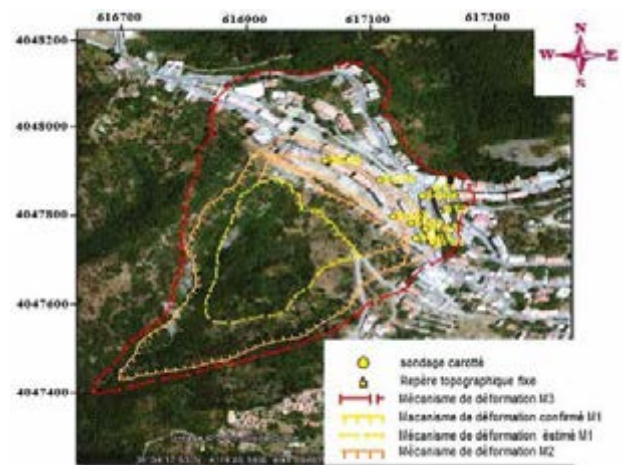
Figure 5 Mécanismes de déformation du glissement.
