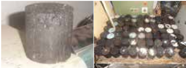
Figure 6: Éprouvettes de BB confectionnées au laboratoire SOIL & WATER INVESTIGATION S.A
