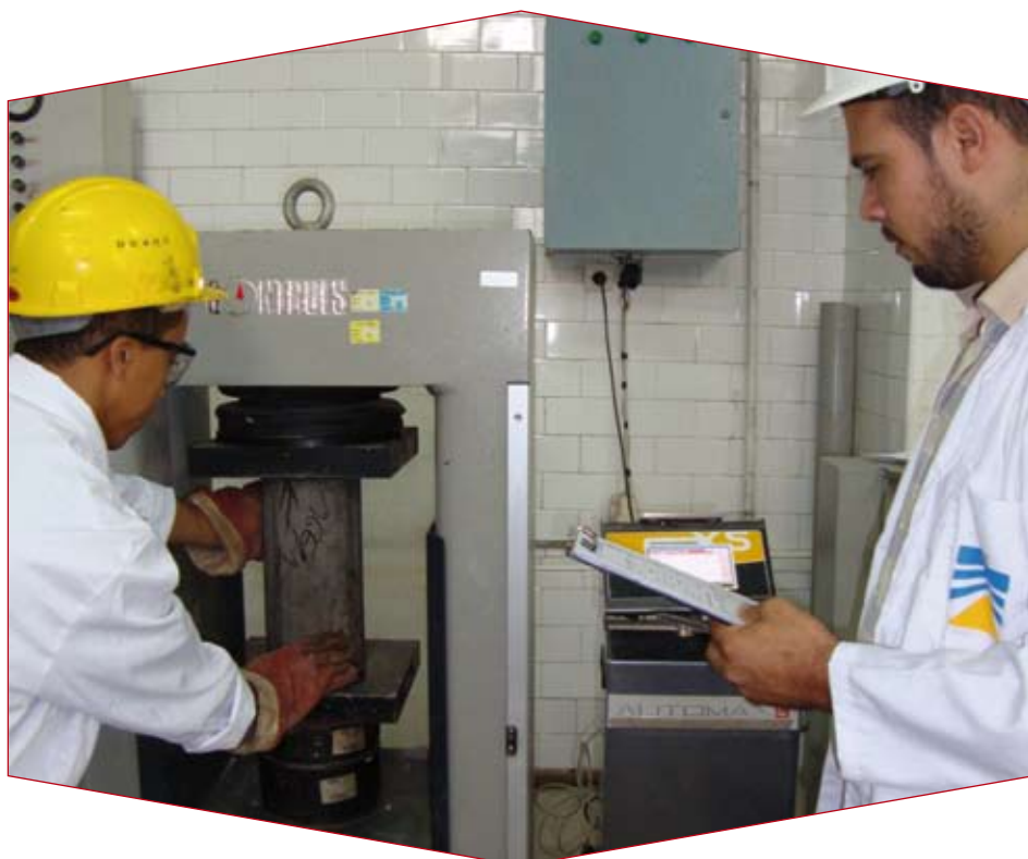
Des agents du CTR de Casablanca en train de réaliser un essai de compression selon la norme NF EN 12390-3
