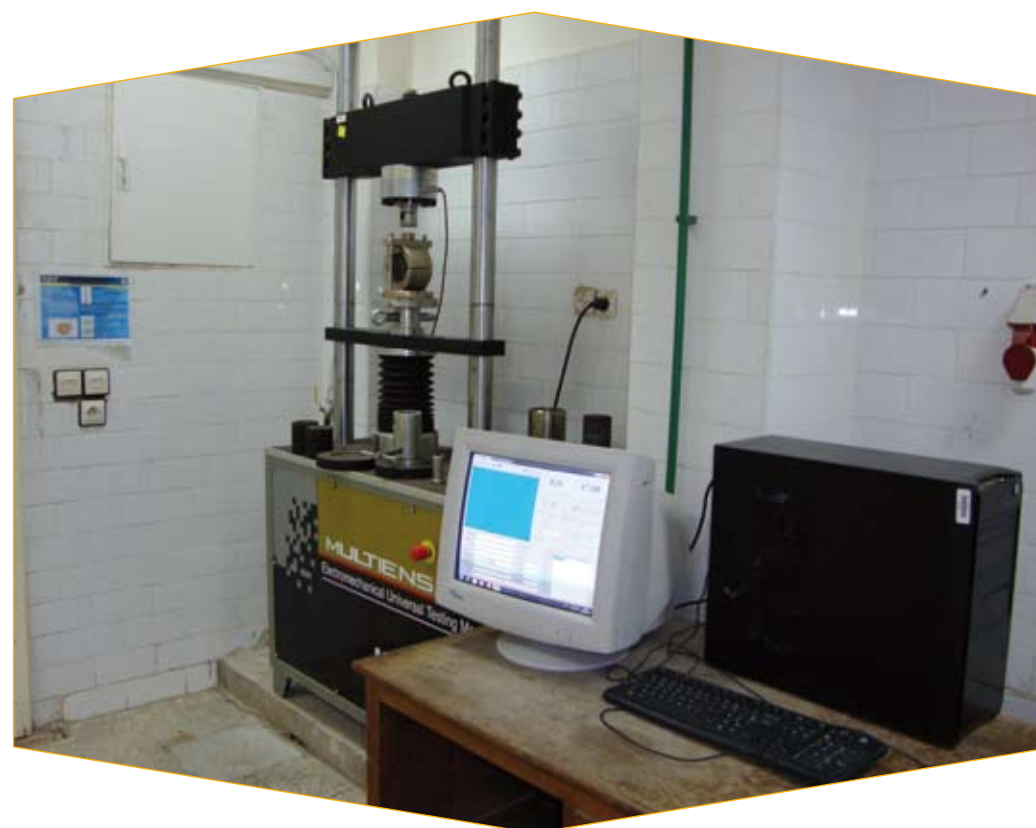
Essai Marshall pour la détermination du fluage et de la stabilité sur un échantillon de béton bitumineux selon la norme NF P98-251-2
